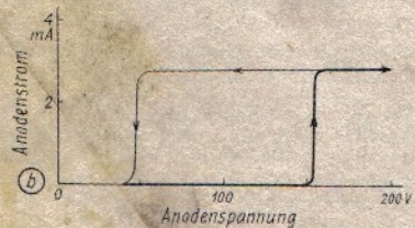
Abb. 3. Grundsätzlicher Aufbau der Transistron-Miller-Schaltung für die Erzeugung von Sägezahnspannungen. Unter dem Schaltbild: Anodenstromzyklus etwa für die Verhältnisse R_1 = 200\text{ k}\Omega , U_{G2} = 200\text{ V} , U_{G1} = 150\text{ V}
